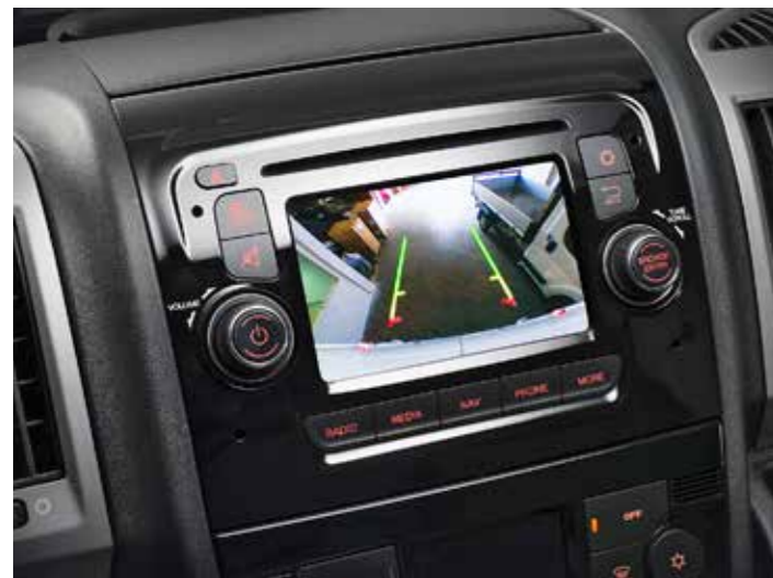
Achteruitrijcamera met weergave op een 5" touchscreen
